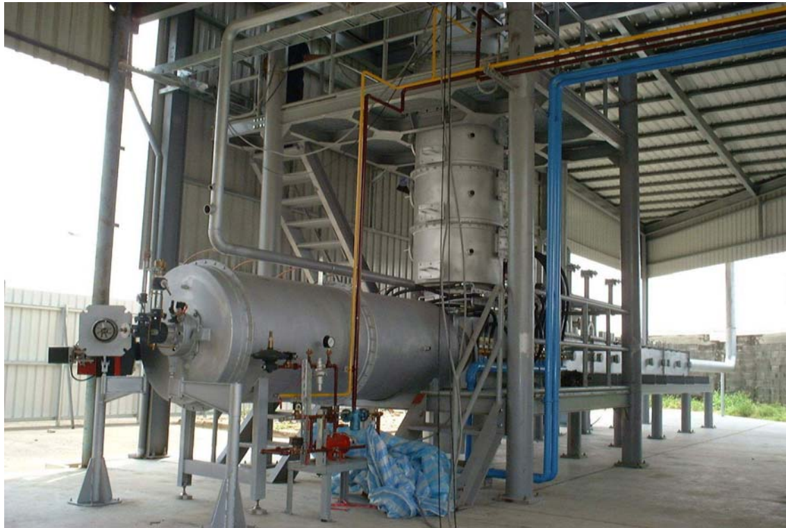
圖 2 多種燃料燃燒測試設備照相圖
